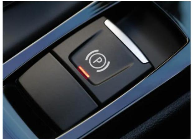
Es gibt bei den elektrischen Handbremsen unterschiedliche Modelle. Einige elektrische Handbremssysteme greifen über 6 km/h gar nicht in die Bremse ein, andere funktionieren eher wie "herkömmliche" Handbremsen oder bremsen über das ABS ab. Einige sind vom Beifahrersitz erreichbar, andere nicht.
