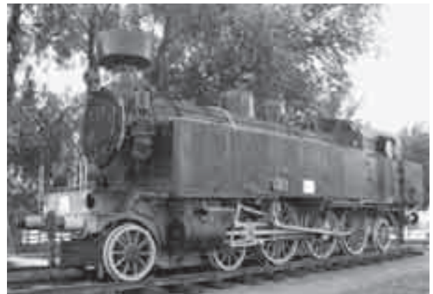
Die im Berichtsjahr unter Denkmalschutz gestellte Lokomotive BBOE 629.65 (No. 77.249) mit Baujahr 1927 wird fahrtüchtig restauriert und als Zeugnis der liechtensteinischen Verkehrs- und Eisenbahngeschichte bald wieder auf den Schienen anzutreffen sein.
